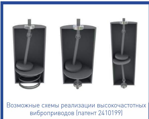
Возможные схемы реализации высокочастотных виброприводов (патент 2410199)
