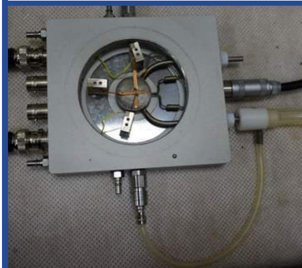
Ячейка для проведения низкотемпературных измерений с помощью импедансной спектроскопии
