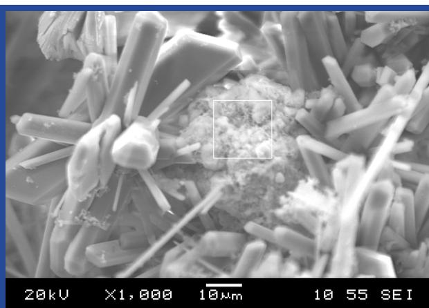
Фрагменты новообразований тяжелых металлов на поверхности перспективных материалов-минерализаторов
