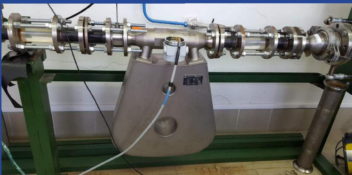
Испытания расходомера на гидропробивочном стенде
