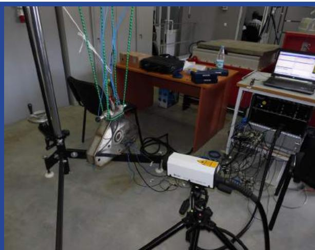
Измерение экспериментальных передаточных функций
