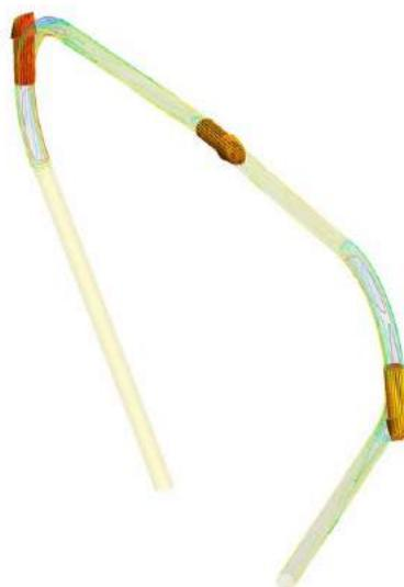
Распределение скоростей в потоке текущей среды в различных сечениях трубопровода
