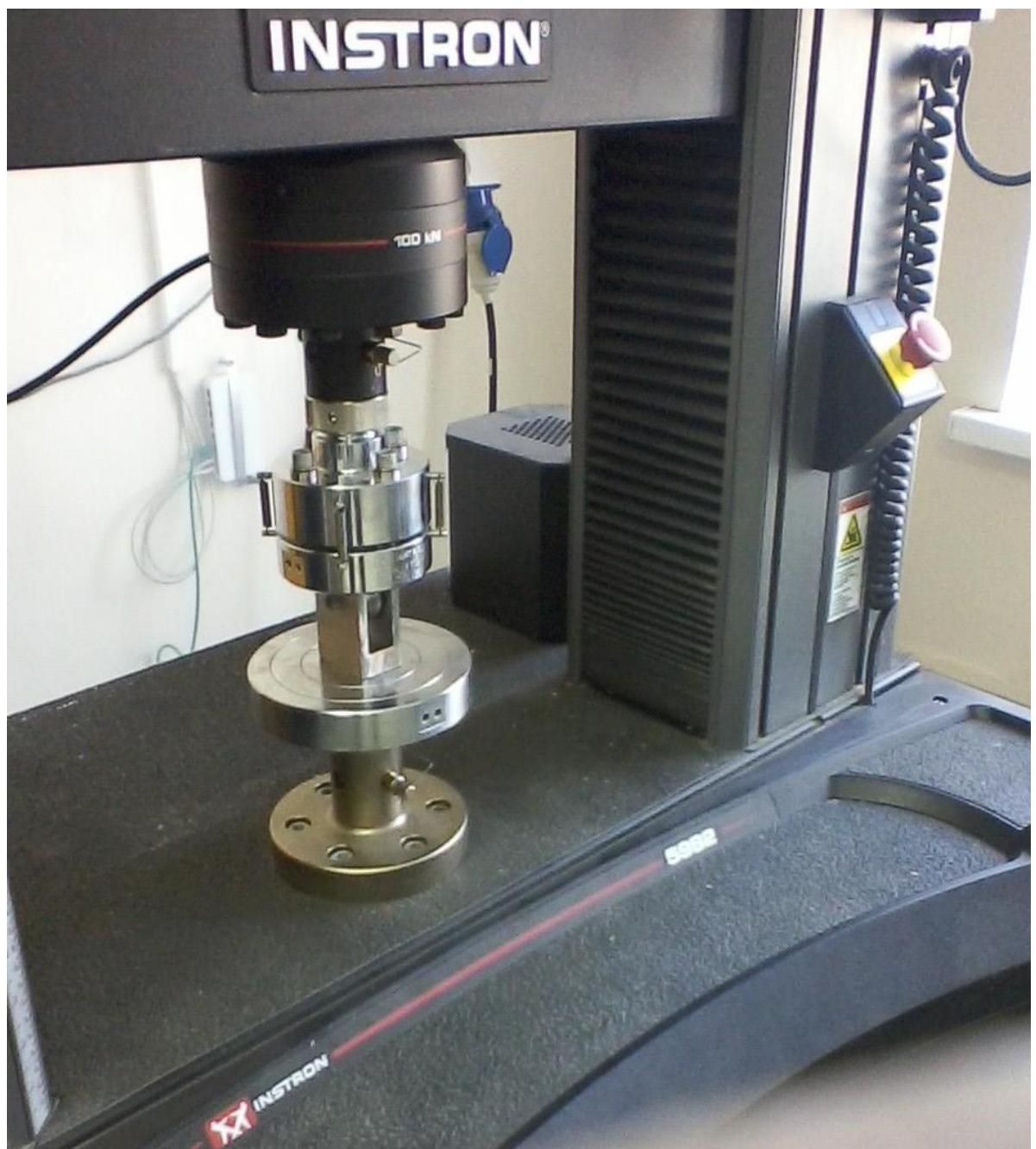
Рисунок 5.6 - Экспериментальное определение деформации элементов планетарной передачи
