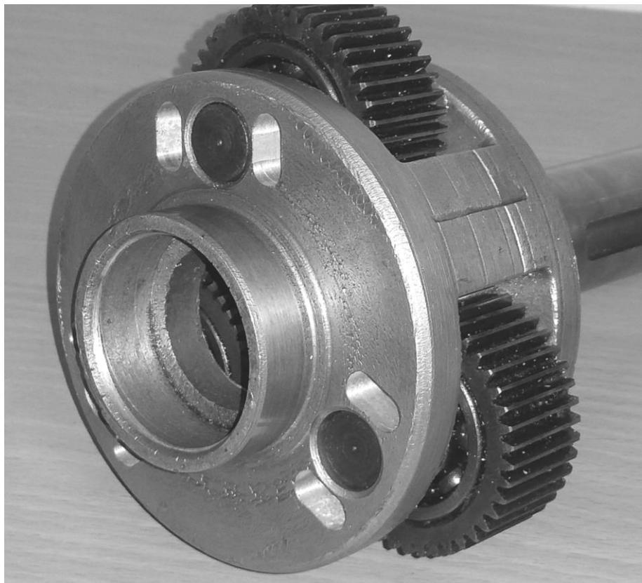
Рисунок 5.12 - Опытный образец планетарной передачи с податливым водилом
