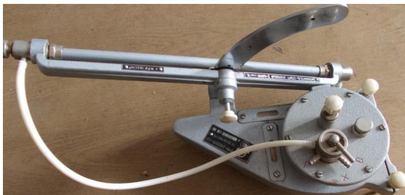
Рисунок 3.4 – Микроманометр многопредельный с наклонной трубкой ММН
