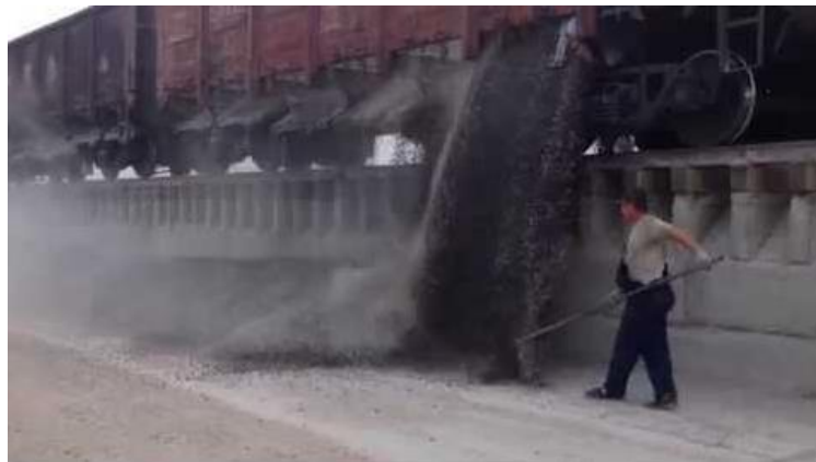
Рисунок 1.13 – Разгрузка полувагона путем открытия люков
